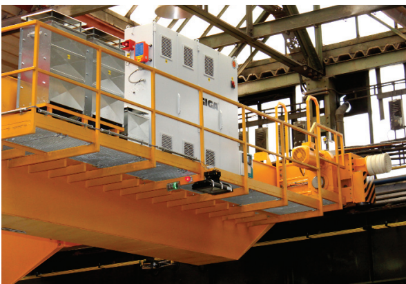
Detaly instalovaného mostového jeřábu GIGA
