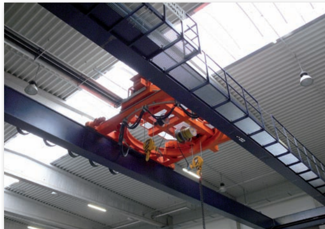
Мостовой кран GIGA mup GDMJ 20t/24,8m с поворотной тележкой
