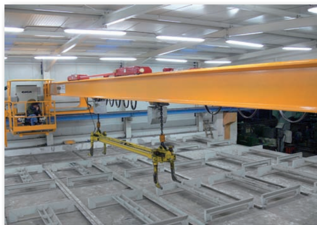
Двухбалочный мостовой кран GIGA mup GDMJ 3,2t+3,2t/14m
