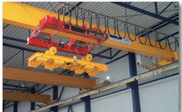
Мостовой кран GIGA min GJMJ 4,4t/27,5m с магнитной траверсой с канатной стабилизацией
