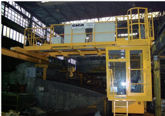
Двухбалочный мостовой кран GDMJ 3,2t/6m сортировочный с кабиной и взвешиванием
