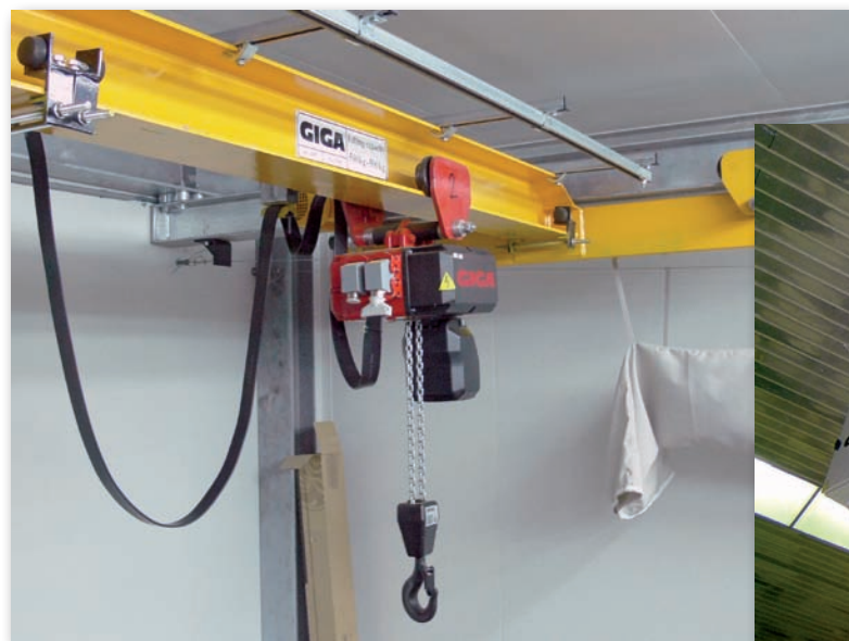
Электрический цепной тельфер CH1 500.4-J, установленный на подвесном мостовом кране GIGA mun GPMJ 2x 0,5т-4,2м. Заказчик - Benteler, s.r.o., Либерец, место установки - Австрия
