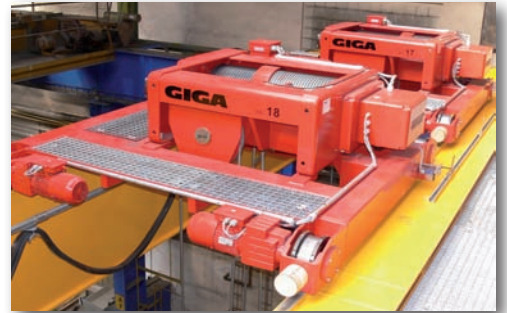
Двухбалочный мостовой кран GDMJ 20t+20t/16,5m
