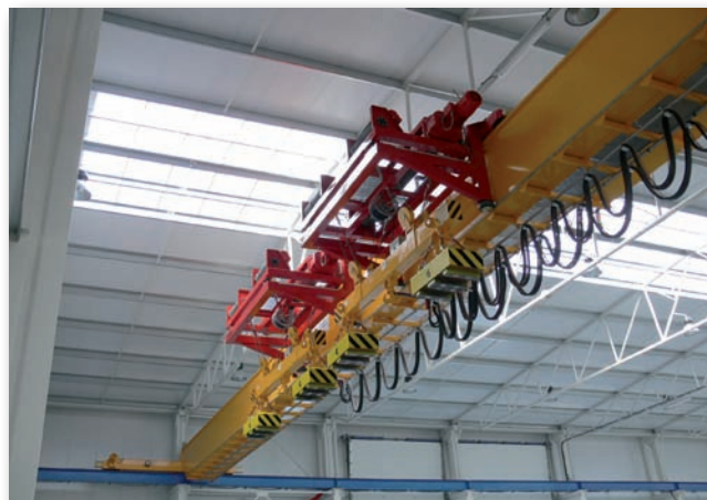
Однобалочный мостовой кран GKMJ 2x3t/28,5m с консольной талью и канатной стабилизацией магнитной траверсы
