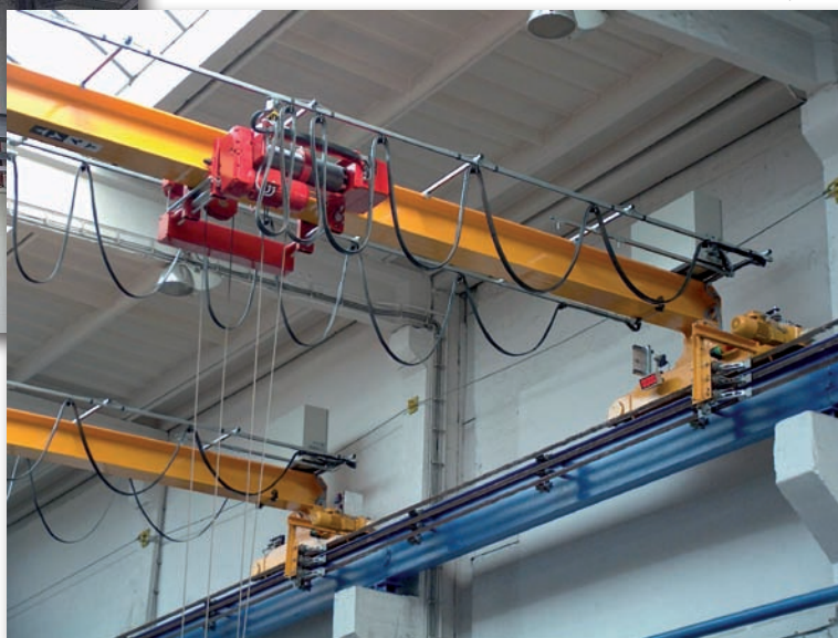
Однобалочные мостовые краны GIGA с технологическим взвешиванием груза
