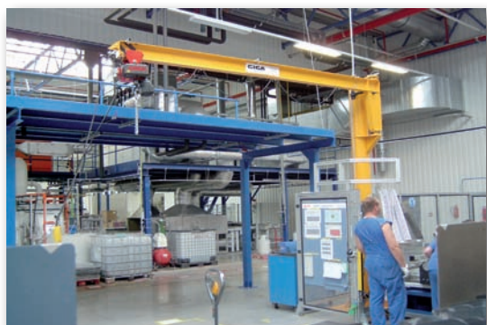
Колонный поворотный кран GSOJ 0,125t/4m
