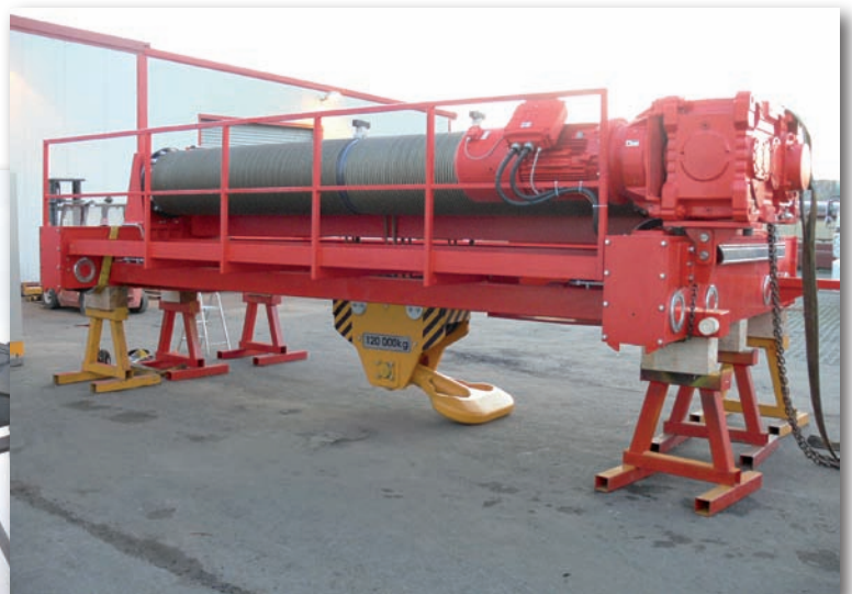
Крановая тележка GWF-120t с грузоподъёмностью 120т, установленная на мостовом кране GDMJ 120t/50t/41,25m Место установки – электростанция Ledvice, Чехия
