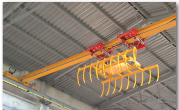
Мостовой кран GJMJ 2x0,8t/16m с грейфером для поднятия сена. Кран оснащён системой, предотвращающей раскачивание.
