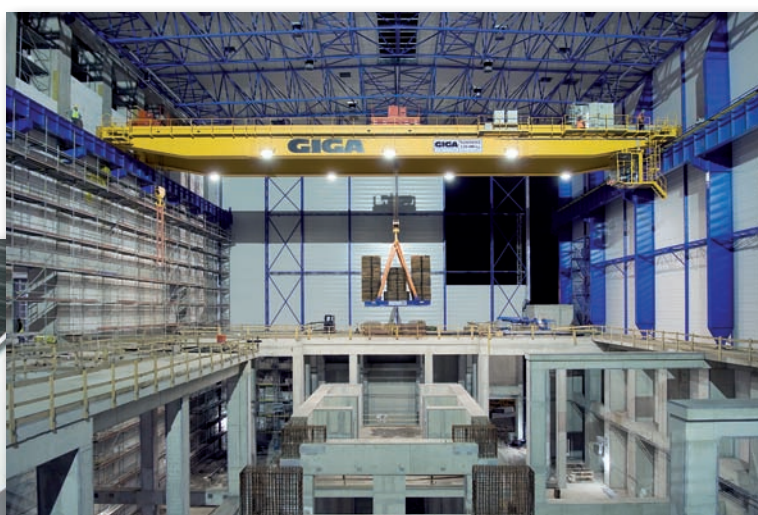
Двухбалочный мостовой кран GDMJ с грузоподъёмностью 120т/50т и пролётом 41,25м в электростанции Ledvice
