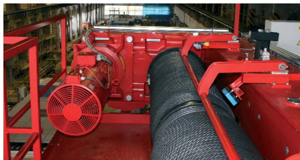
Buben hlavního zdvihu s tenzometry při seřizování
