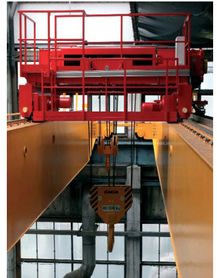
Jeřábová kočka s hlavním a pomocným zdvihem
