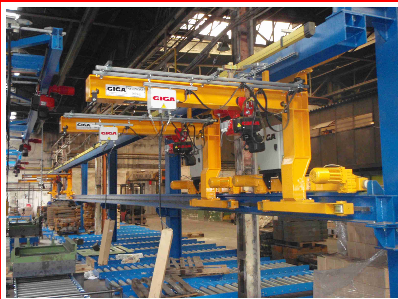
■ Konzolový mostový jeřáb typ GKMJ 0,16t/2,5m
