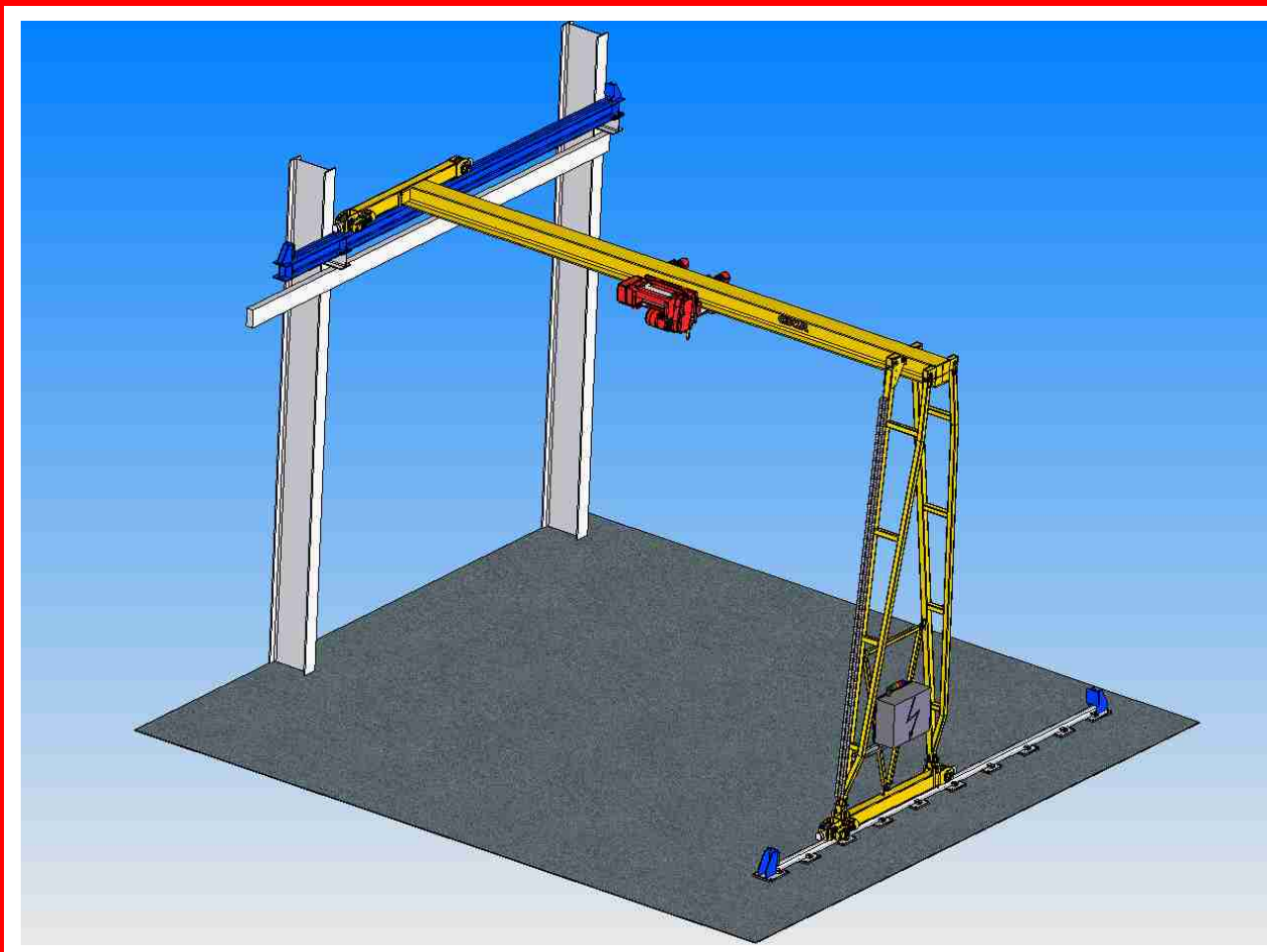
■ Poloportálový mostový jeřáb typ GPMJ 1t/8,55m
