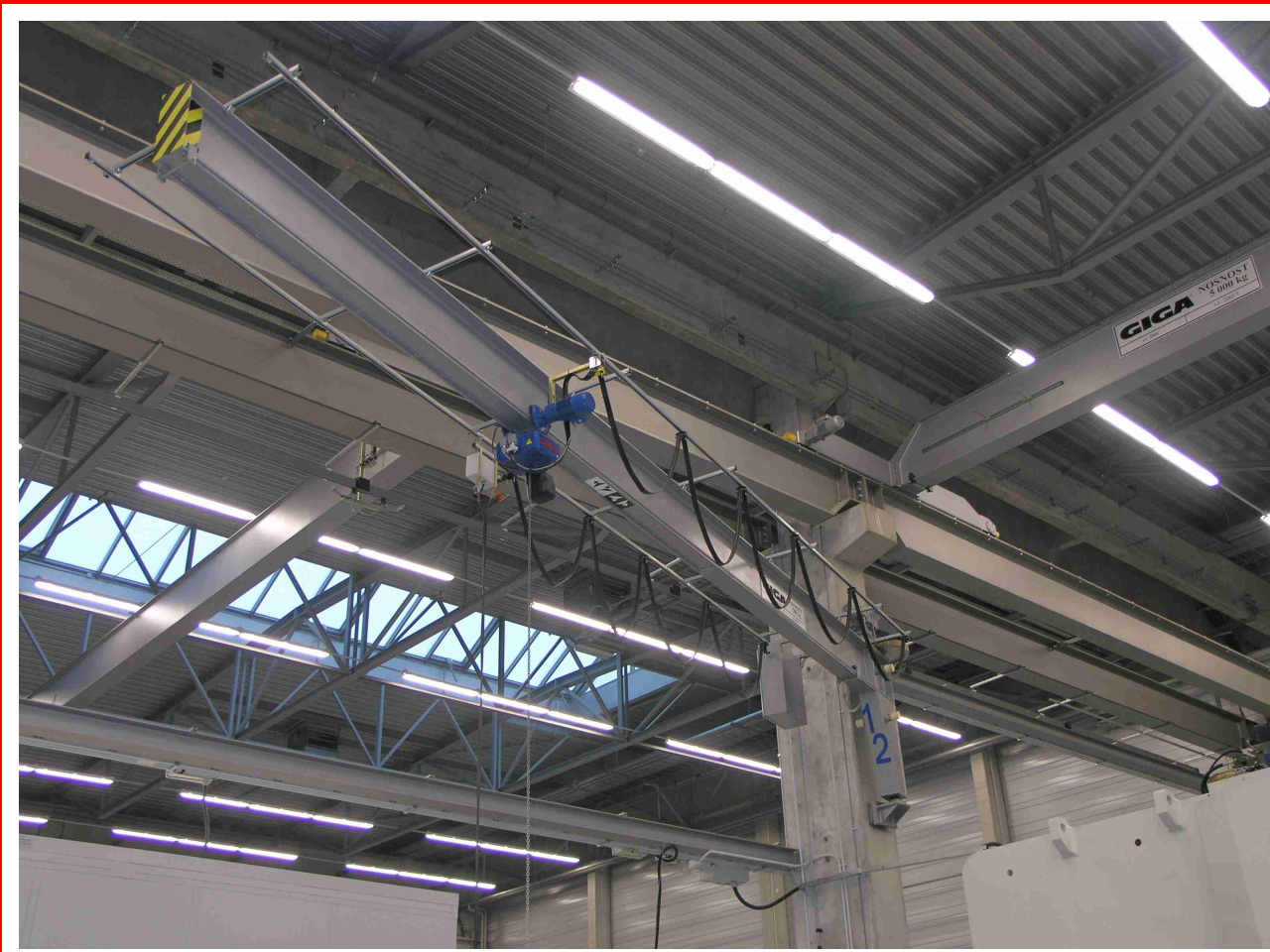
■ Konzolový otočný jeřáb typ GKOJ 1t/7m
