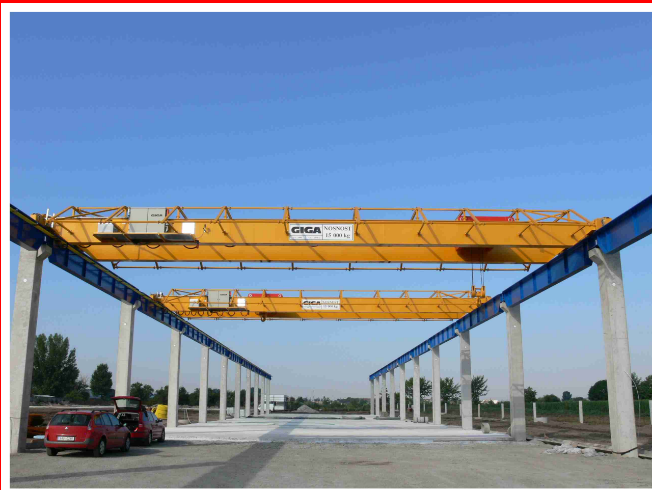
■ Dvounosníkový mostový jeřáb typ GDMJ 15t/19,2m
