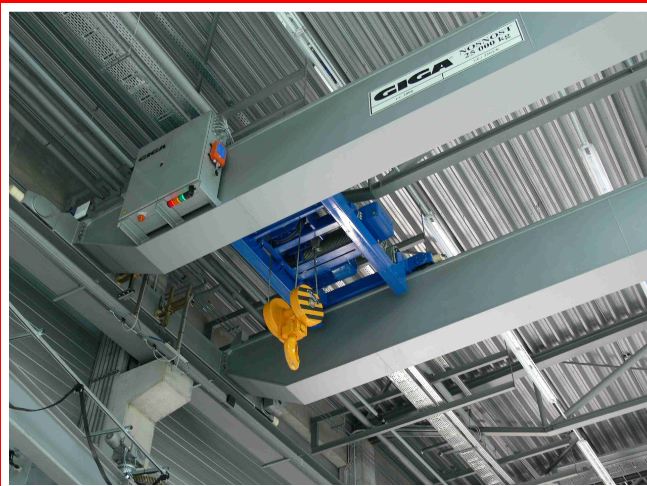
■ Dvounosníkový mostový jeřáb typ GDMJ 25t/22,6m
