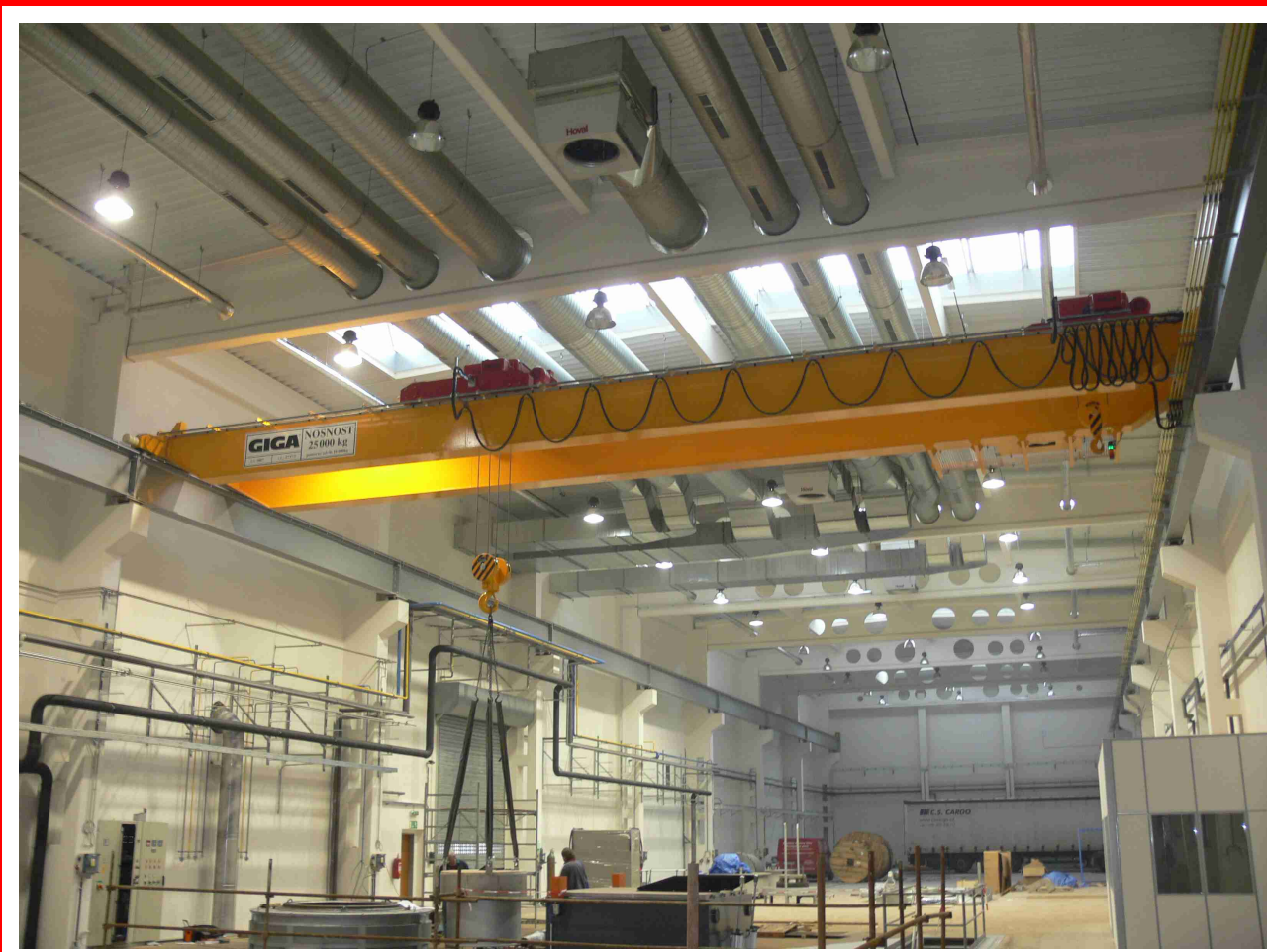
■ Dvounosníkový mostový jeřáb typ GDMJ 25t/10t/22,55m
