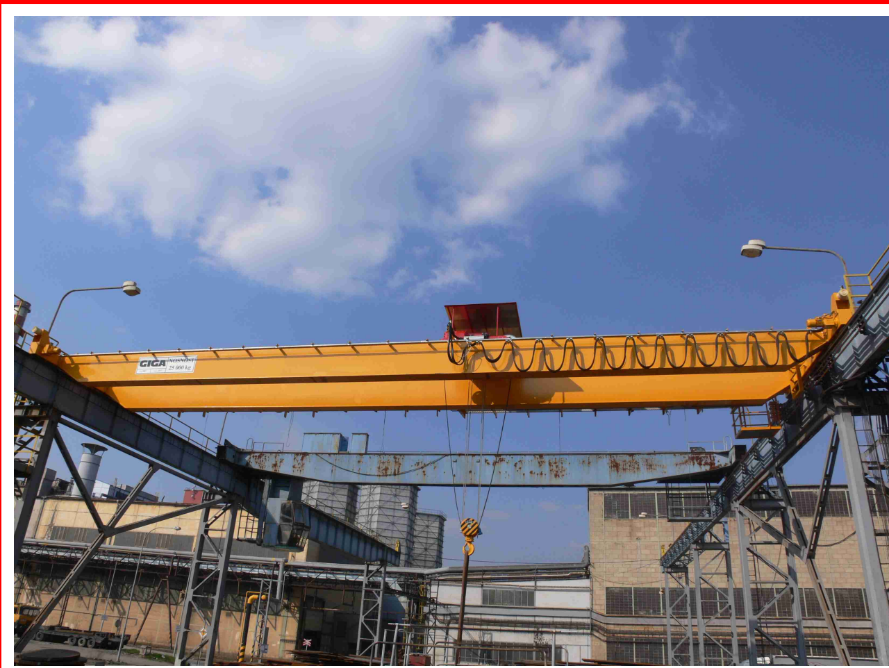
■ Dvounosníkový mostový jeřáb typ GDMJ 25t/22,5m
