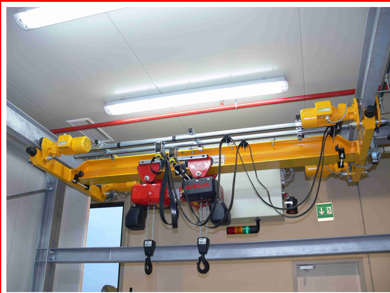
■ Podvěsný mostový jeřáb typ GPMJ 2x0,5t/4,2m
