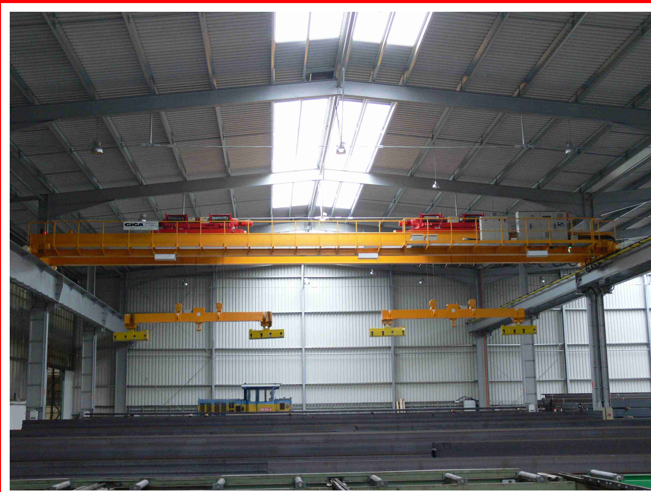
■ Dvounosníkový mostový jeřáb typ GDMJ 2x5t/25,5m s lanovou stabilizací na magnetové traverze
