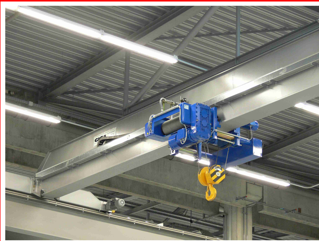
■ Jednonosníkový mostový jeřáb typ GJMJ 12,5t/22,6m
