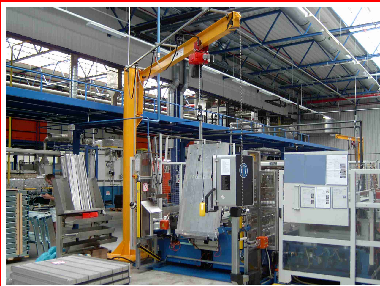
■ Sloupový otočný jeřáb typ GSOJ 0,125t/4m
