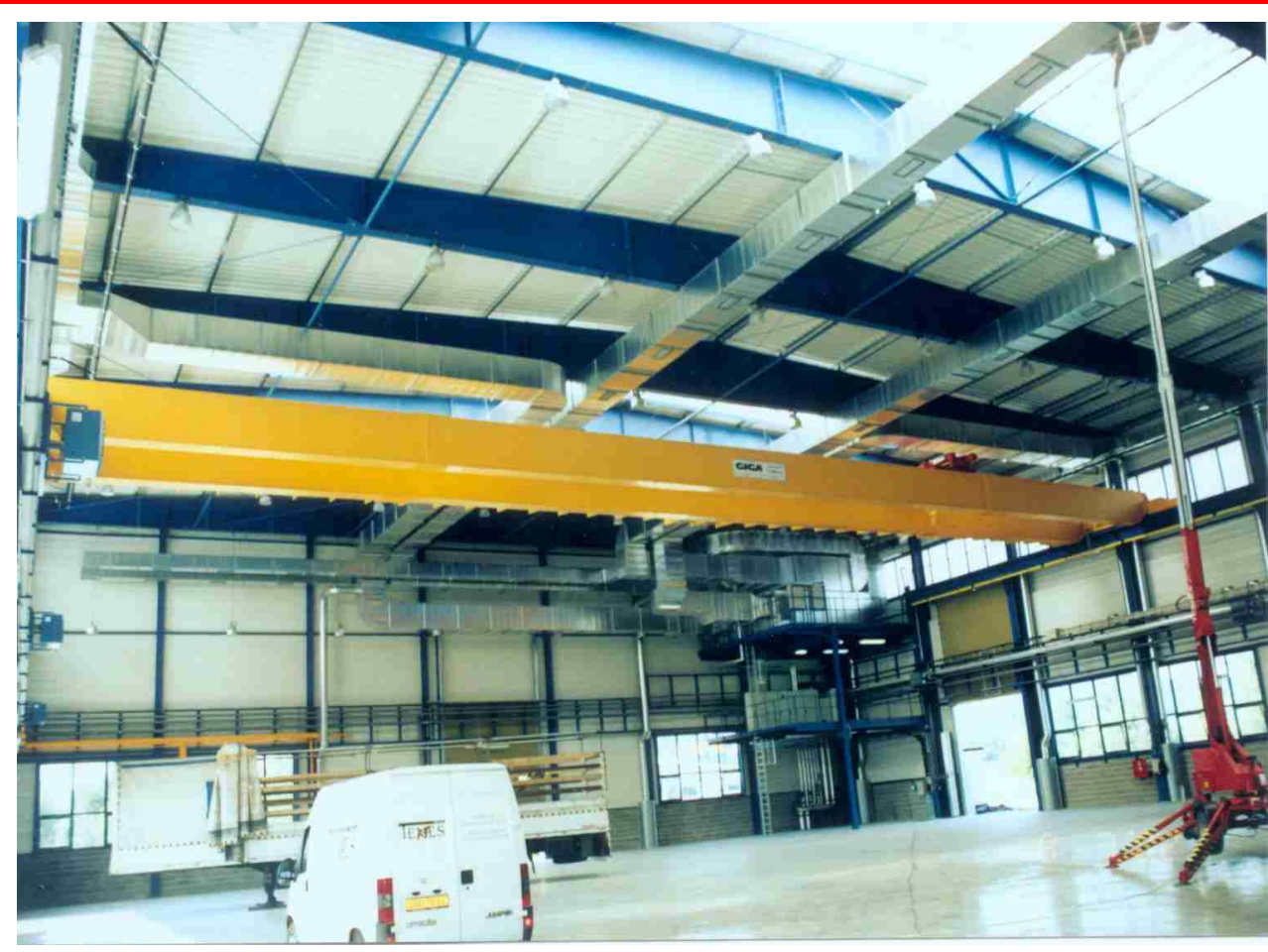
■ Dvounosníkový mostový jeřáb typ GDMJ 15t/38m
