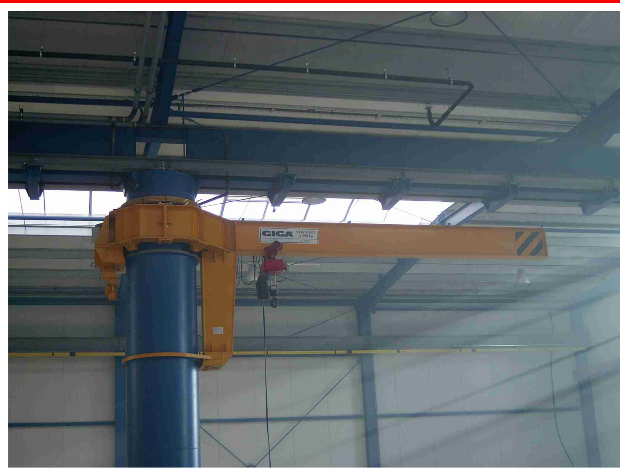
■ Sloupový otočný jeřáb kolem sloupu haly typ GKOJ 2t/6m
