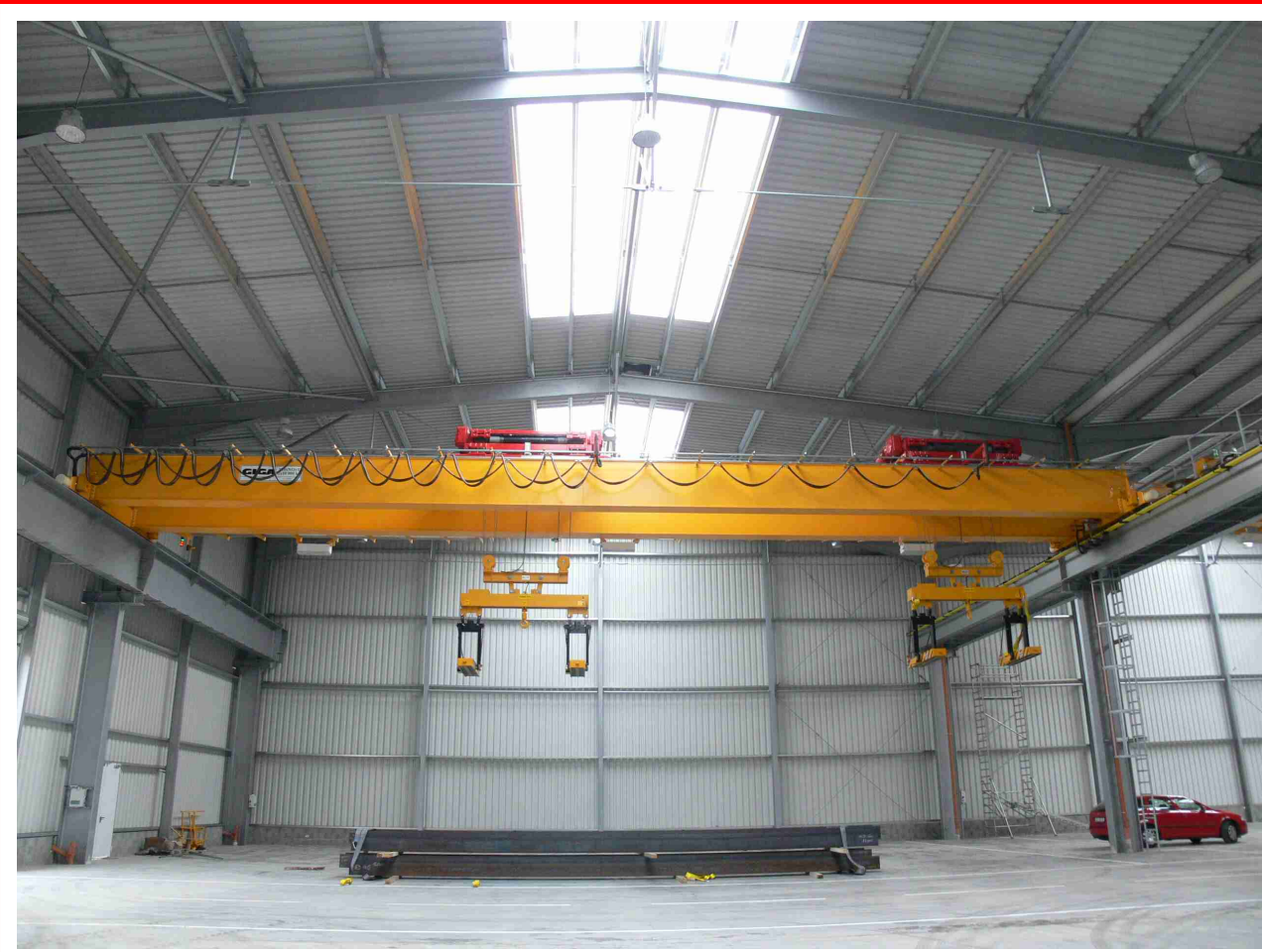
■ Dvounosníkový mostový jeřáb typ GDMJ 2x10t/25,5m s lanovou stabilizací na magnetové traverze
