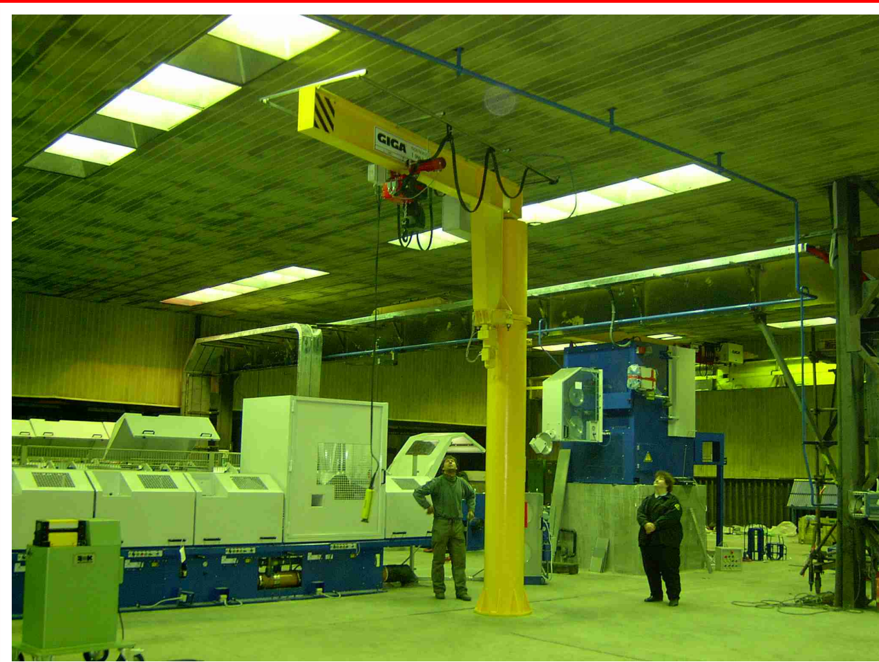
Sloupový otočný jeřáb typ GSOJ 1t/3,25m
