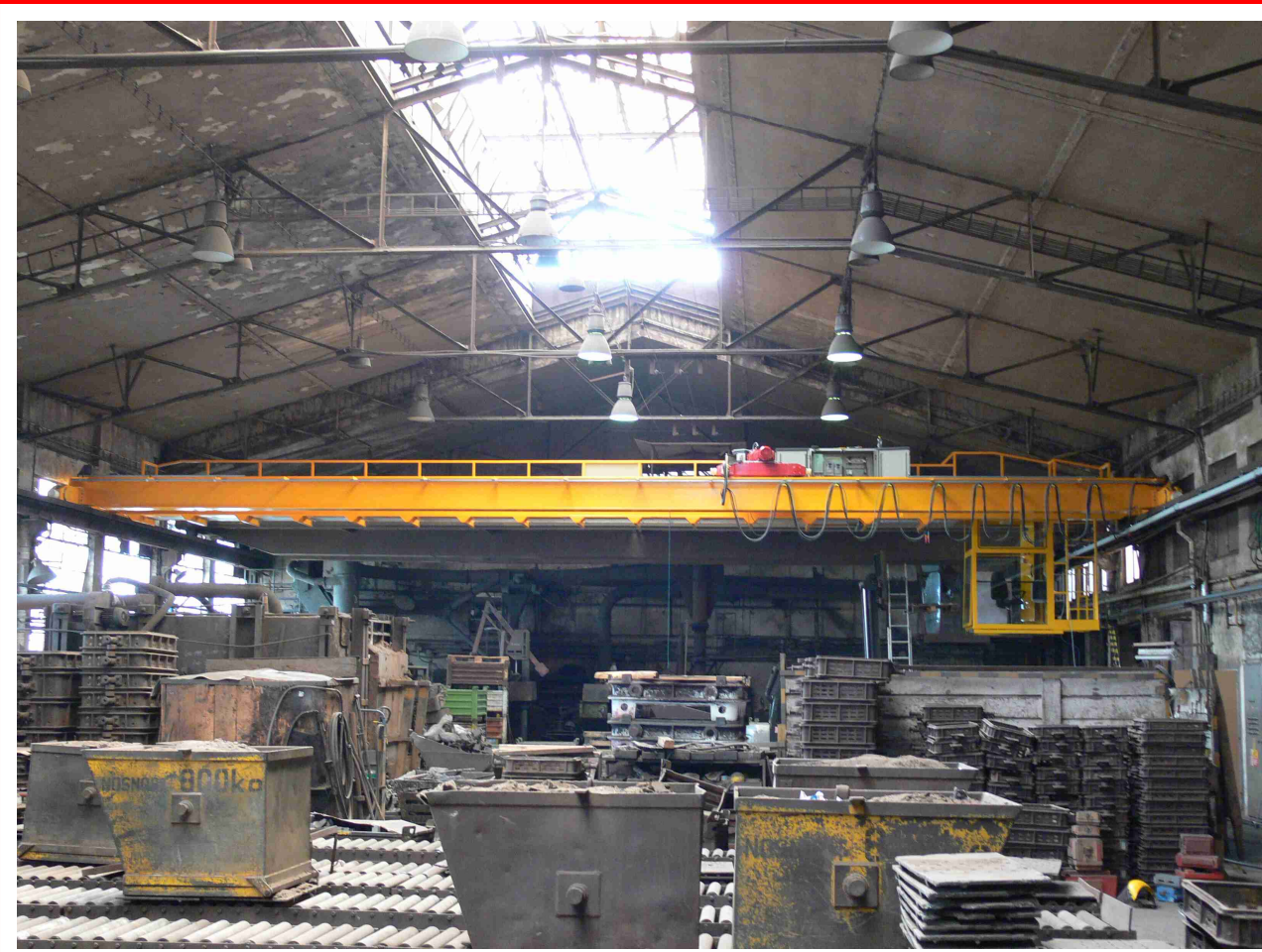
■ Dvounosníkový mostový jeřáb typ GDMJ 5t/18,4m slévárenské provedení s kabinou
