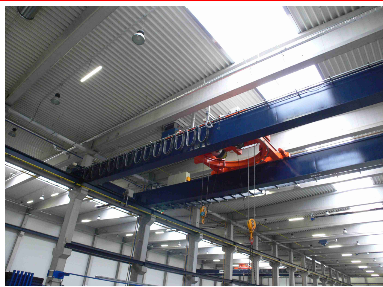
■ Dvounosníkový mostový jeřáb s otočnou kočkou typ GDMJ 20t/24,8m
