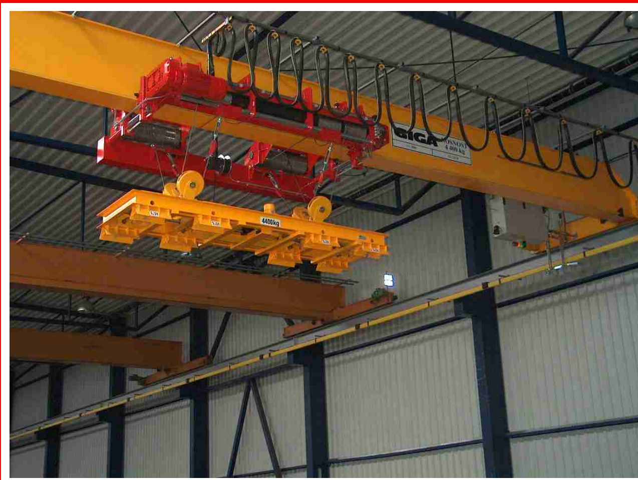
■ Jednonosníkový mostový jeřáb s lanovou stabilizací typ GJMJ 4,4t/27,5m
