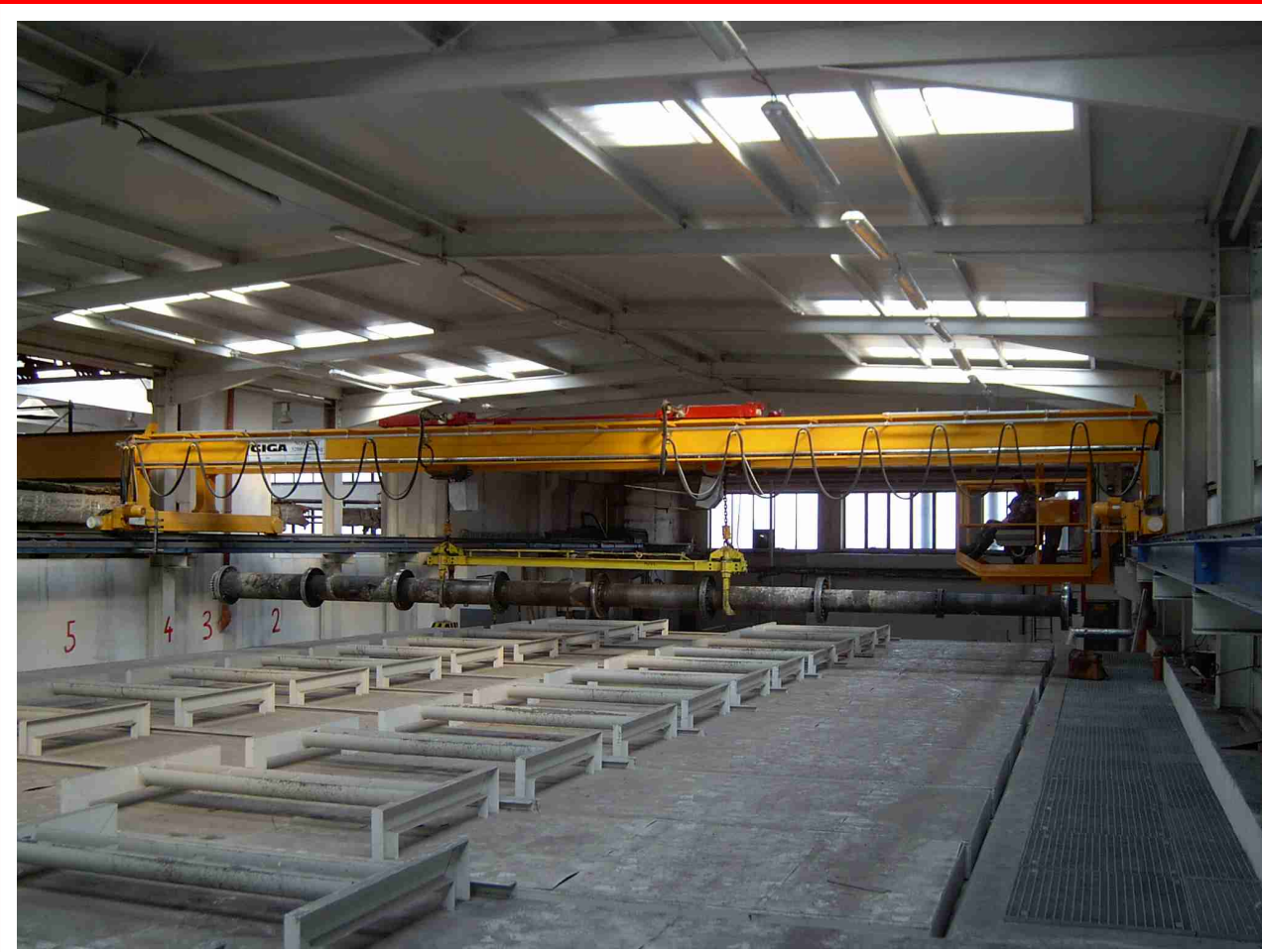
■ Dvounosníkový mostový jeřáb typ GDMJ 3,2t+3,2t/14m
