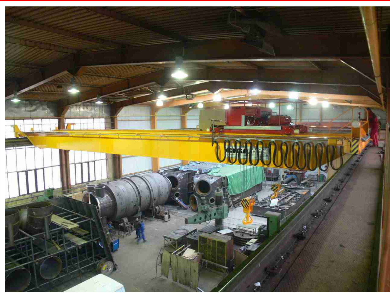
■ Dvounosíkový mostový jeřáb typ GDMJ 45t/12,5t/21,9m
